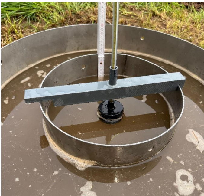
Abbildung 18: Das eingebrachte Doppelring-Infiltrometer mit Schwimmer und Zollstock. Beide Ringe mit gleichem Füllstand.
