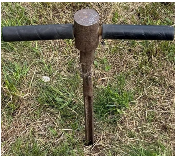
Abbildung 19: Pürckhauer-Hohlmeißel mit sichtbarem Hohlraum für das Bodenprofil.
