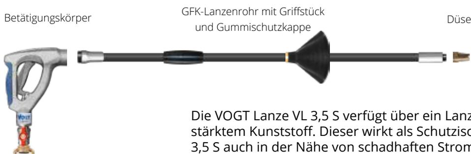
Die VOGT Lanze VL 3,5 S verfügt über ein Lanzenrohr aus glasfaserverstärktem Kunststoff. Dieser wirkt als Schutzisolierung, sodass mit der VL 3,5 S auch in der Nähe von schadhaften Stromleitungen und anderen stromführenden Geräten gearbeitet werden kann.
