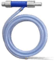
Der VOGT Strahlaufsatz ergänzt die VOGT Lanze um eine Ansaugvorrichtung für Strahlgut. Dieses wird durch eine Schlauchleitung eingesaugt und der entweichenden Druckluft beigemischt. So lassen sich sogar extrem hartnäckige Beläge wie Graffiti, Bitumen oder Farbanstriche rückstandslos entfernen.
