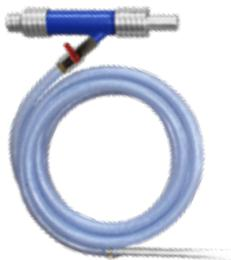
Der VOGT Sprühaufsatz ergänzt die VOGT Lanze um eine Ansaugvorrichtung für Flüssigkeiten. Diese werden durch eine Schlauchleitung eingesaugt und der entweichenden Druckluft beigemischt. Eine spezielle Düse sorgt für eine feine Zerstäubung und gleichmäßige Verteilung.
