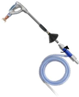
Achten Sie beim Einsatz des VOGT Strahlaufsatzes darauf, dass das Strahlgut trocken und klumpenfrei ist. Feuchtes Strahlgut verklumpt und ist eine häufige Ursache für Betriebsstörungen. Maximale Korngröße 1,5 mm.
